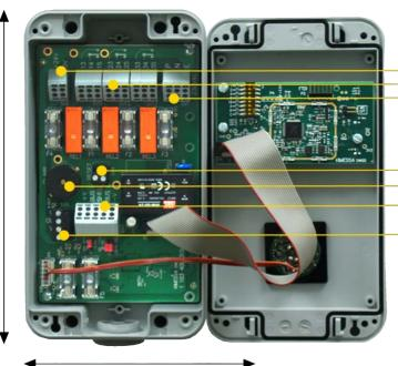
24 VDC Speisespannung3x Relaisausgänge230 VAC Speisespannung
