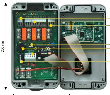
24 VDC Speisespannung3x Relaisausgänge230 VAC Speisespannung
