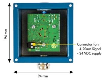
Gain-Potentiometer 4-20 mA jack 3,5 mm Zero-Potentiometer
